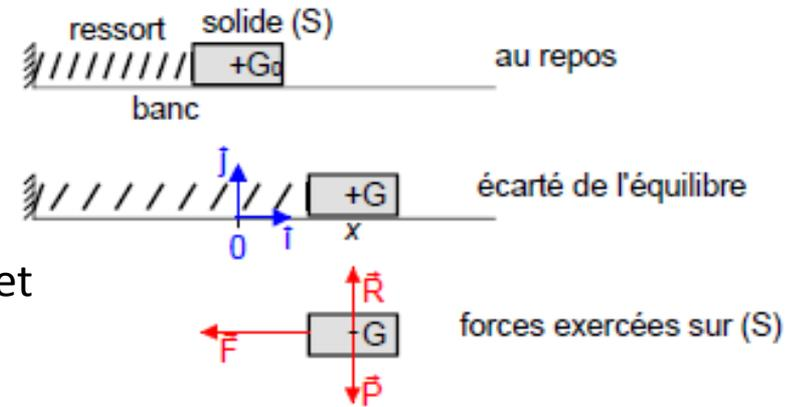
Si l'on écarte le centre d'inertie G du solide, il se met à osciller autour de G0
