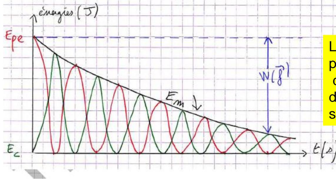
L'Énergie Mécanique n'est plus conservée au cours des oscillations, elle est dissipée par les frottements sous forme de chaleur.
