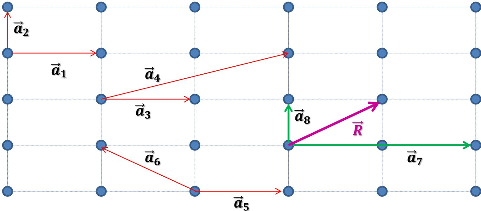
$$\vec{R} = \vec{a}_1 + \vec{a}_2 = -\vec{a}_3 + \vec{a}_4 = 2\vec{a}_5 + \vec{a}_6$$
