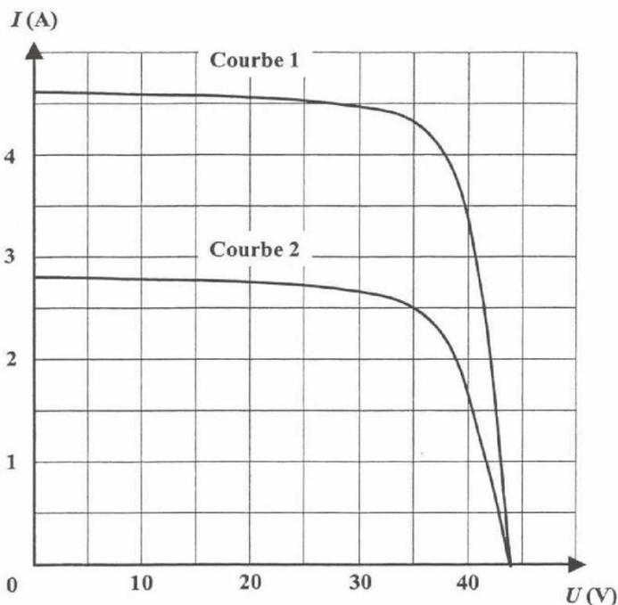
1/ Etude dans le cas d'un ensoleillement optimal : la caractéristique courant-tension correspond à **la courbe 1**.
