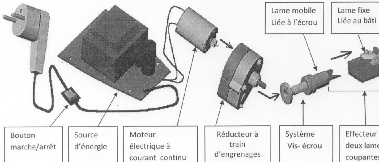
**6- Ensemble éclaté du système électromécanique :**
