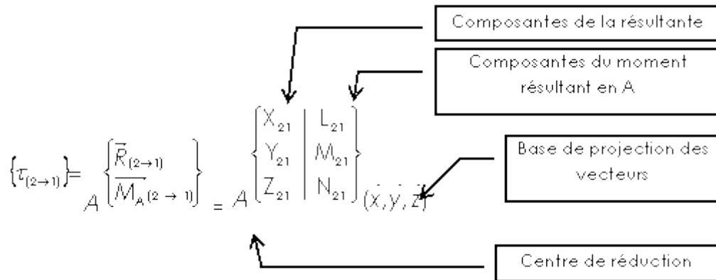
Le toseur associé à l'action mécanique exercée en A, par un solide 2 sur un solide 1 sera noté :
