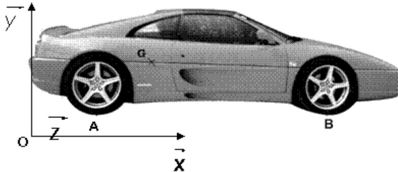
Considérons une Ferrari de masse  $m=1250$  Kg ; La voiture étant immobile, on désire connaître les actions mécaniques sur les pneumatiques au point A et au point B.
