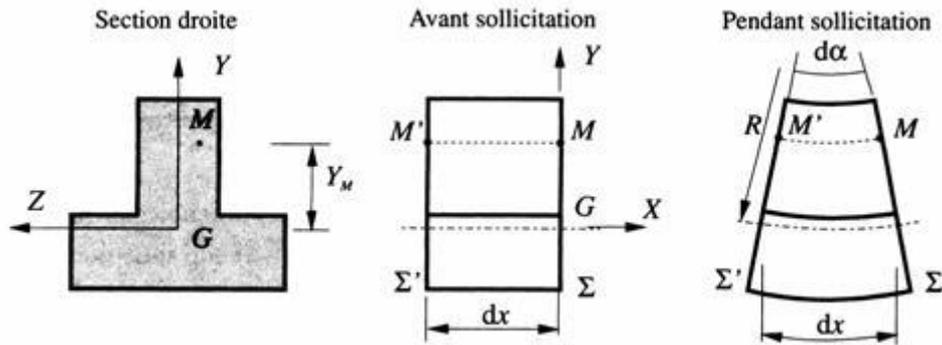
MM' est une fibre du tronçon joignant deux points homologues des sections  $\Sigma$  et  $\Sigma'$
