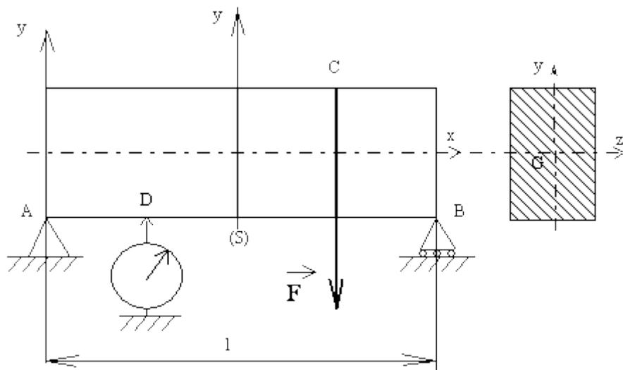
Un comparateur placé en D permet de mesurer la flèche lorsque F varie
