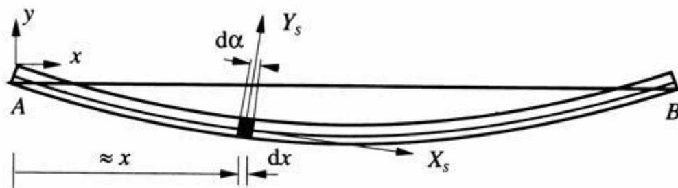
Au cours de la déformation, le tronçon considéré initialement prismatique se transforme en portion de tore de rayon moyen R intercepté d'un angle  $d\alpha$
