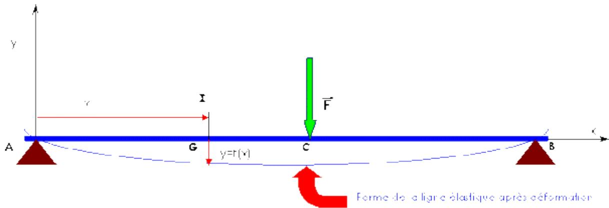
L'axe neutre Ax (ou ligne élastique) se déforme suivant une courbe telle que  $y=f(x)$ .
